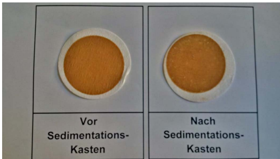
Abbildung 66: getrocknete Filter von Zu- und Ablauf des Sammelkastens, Probenahme 07.09.2016 09:30 Uhr, Ibbenbüren
