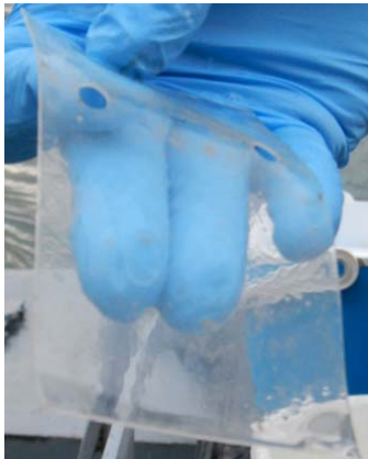
Abbildung 3: Als Passivsammler verwendeter Silikonstreifen [BfG]
