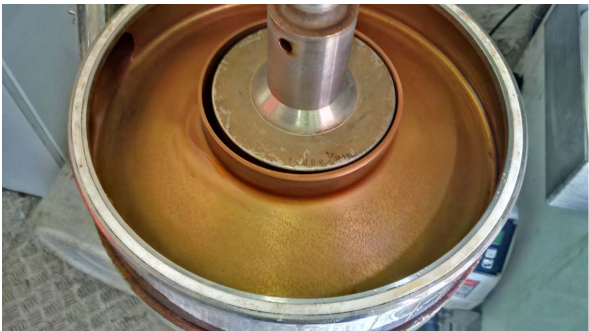
Abbildung 64: Verfärbung der Edelstahlhaube der Schwebstoffzentrifuge nach der Probenahme Carolinenglück am 3.7.2017.
