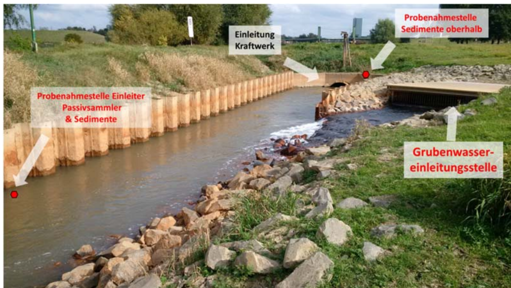
Abbildung 29: Bild der Einleitungsstelle für das Grubenwasser Walsum mit Kennzeichnung der Probenahmestellen für Passivsammler und Sedimententnahme [BfG]
