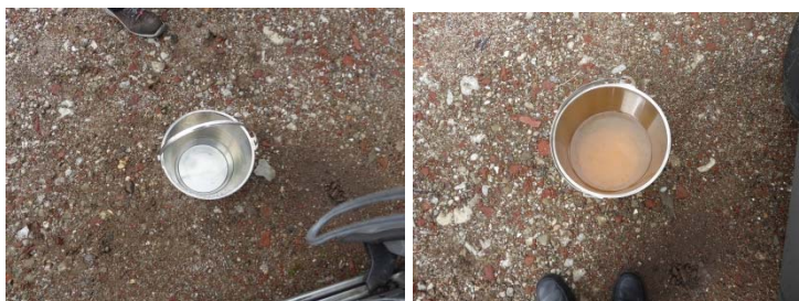
Abbildung 26: Bildung von Eisenoxid im Grubenwasser Duisburg Walsum, links: nach Entnahme aus Druckrohr, rechts: 15 min später
